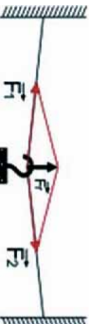
شکل (1-47) د یوې قوی تجزیه د یو جسم په څړپدلي حالت کې (د واټ د برېښنا ګروپ)
