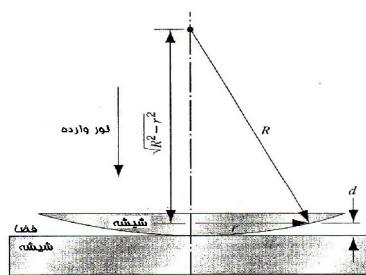
شکل ۳ - ۱۶ : میئله نمونه ۳ - ۵ . دستگاه برای مشاهده حرکات حلقوی نیوتون.
