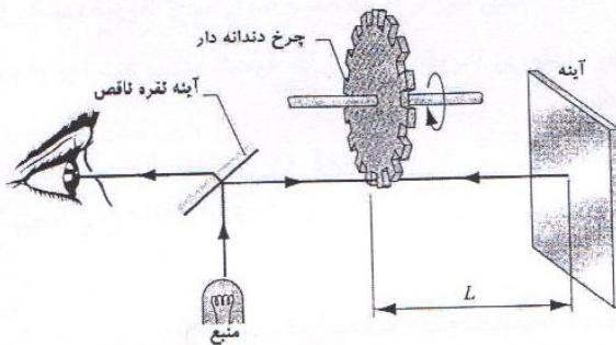
شکل ۹-۱: یک دیاگرام شیماتیک اله Fizeau's جهت اندازه گیری سرعت نور.
