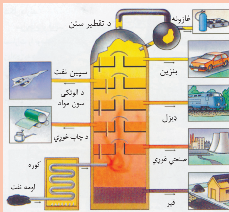
شکل (۲-۱۱): د نفتو د تصفیې دستگاه
