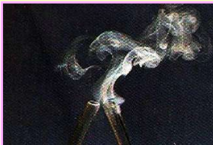
(1 - 5) شکل د لیوس د تیزاب - القلیو تعامل (دامونیا تعامل د بورون ترای فلوراید سره)
