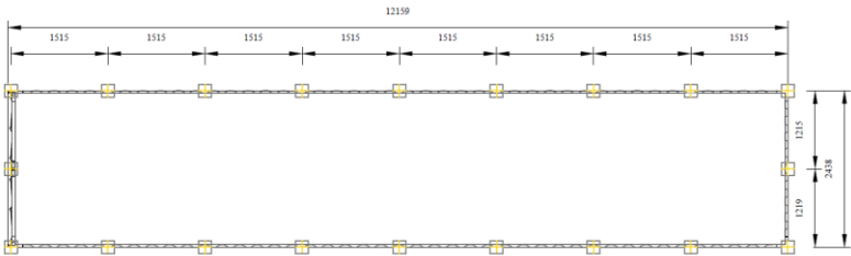
پلان بلوک کانکریتی ۲۰۰ در ۲۰۰ ملی متر برای کانتینر ۴۰ فوت، مارک ۱:۳
